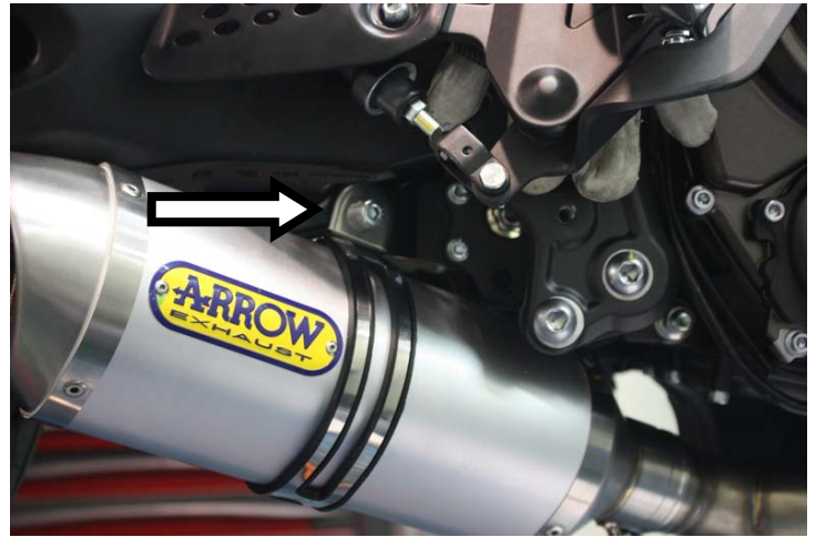
Serrare il terminale alla staffa mediante fascetta verificando la corretta distanza dal forcellone Secure the silencer to the bracket using the clamp. Check clearance from swingarm
