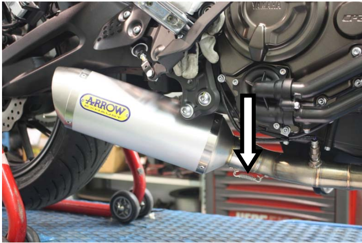
Innestare il terminale ed ancorare la molla Fit the silencer and secure the spring
