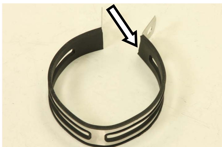
Alloggiare e tagliare a misura la guarnizione per fascetta di sostegno (se presente) If given in the fitting kit, fit the rubber cover to the stainless steel mounting clamp and trim it to the required length
