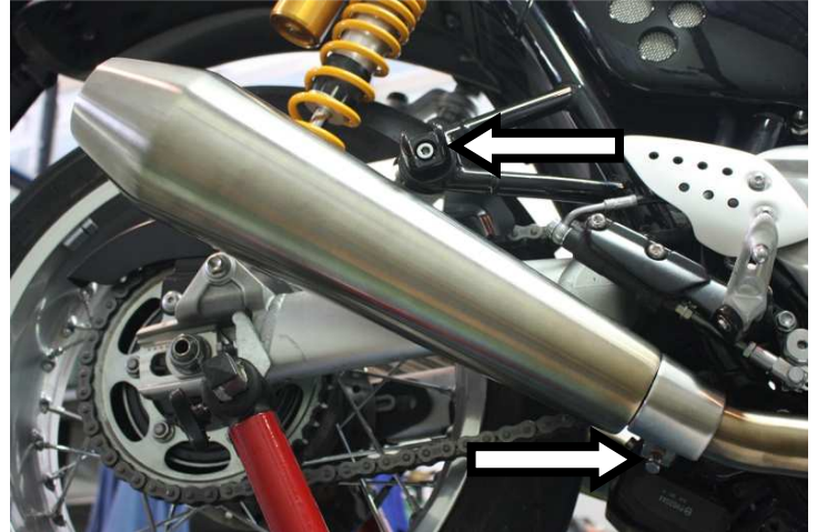
Allentare la fascetta, svitare la vite di fissaggio e rimuovere i terminali DX ed SX Loosen the hose clip, unscrew the fixing screw and remove OE silencers
